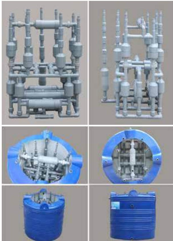
HỆ THỐNG XỬ LÝ NƯỚC BẰNG CÔNG NGHỆ MET WATER TREATMENT SYSTEM WITH MET TECHNOLOGY
